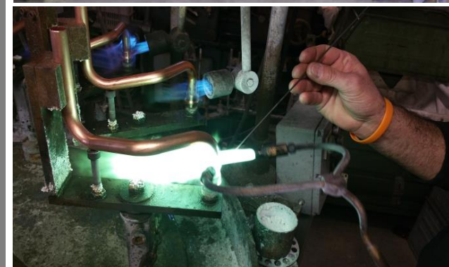
Processo di saldatura manuale- Supporti personalizzati per la massima precisione e conformità
